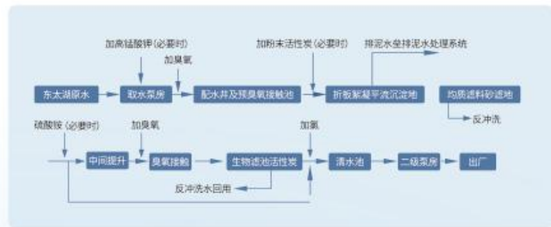
图1 苏南某水厂工艺流程
