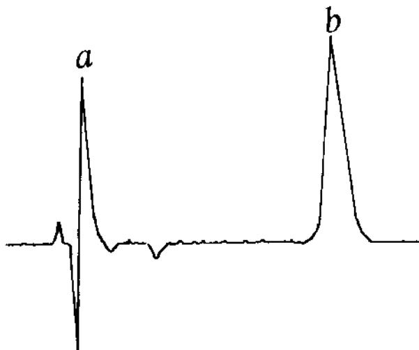
图 91-1 甲萘威标准色谱图 a 溶剂, b 甲萘威
